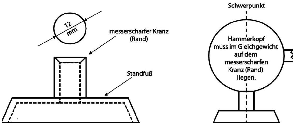
**Zeichnung 28: Empfohlene Vorrichtung zur Prüfung der Lage des Hammerkopfes**
